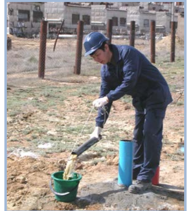
Прокатка скважины для получения репрезентативной пробы
