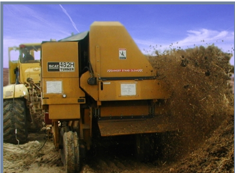
Аэрация сильно загрязненной почвы и нефтешлама с добавлением соломы, в валках на месторождении Узень
