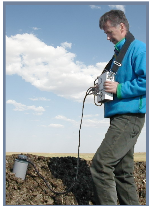
Измерение бактериальной активности путем измерения частоты дыхания почвы CO 2 и изменения температуры почвы
